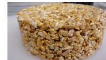
Revêtement de gravas/liant synthétique avec perméabilité minimale de 10^{-3} m/s (procédé PERMEAWAY, photo site MCK Environnement)
