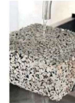
Hydromedia : revêtement poreux à base de liant en béton fortement drainant (photo Lafarge bétons)
