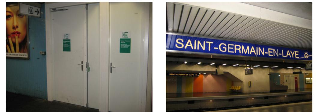
Photo 6 – Espace d'attente sécurisé (EAS) dans des locaux existants au niveau des quais (source RATP)
