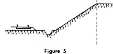
Dans le cas d'une voie posée à flanc de coteau, la limite légale à considérer est constituée par le point extrême des déblais ou remblais effectués pour la construction de la ligne et non la limite du talus naturel (figures 6 et 7).
