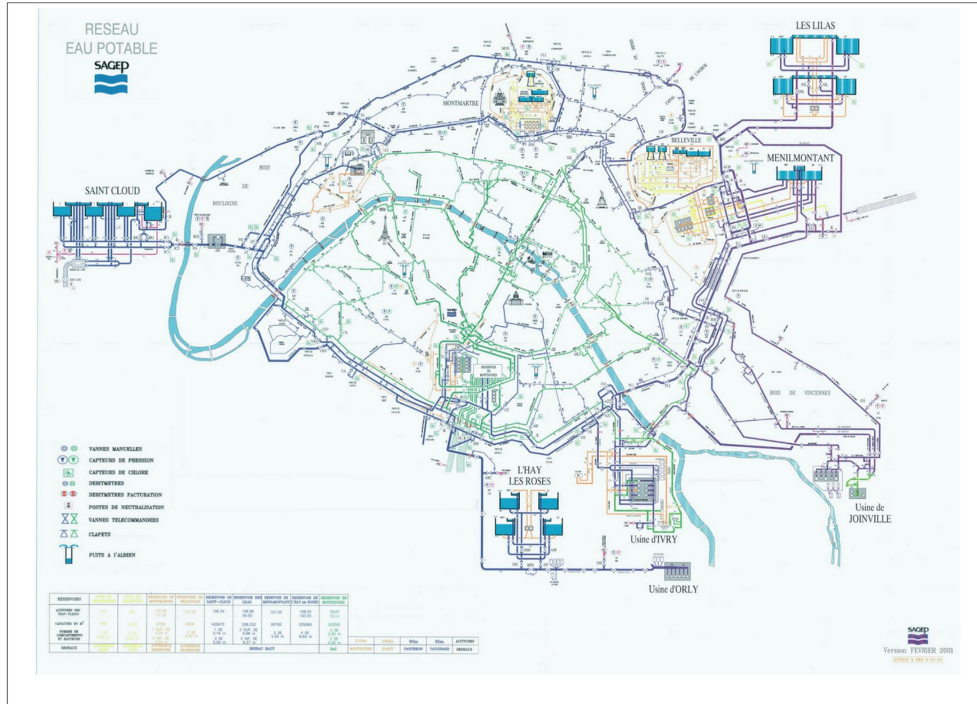
La distribution de l'eau est assurée à Paris par deux réseaux distincts : un réseau d'eau potable et un réseau d'eau non potable. Les conduites constituant ces deux réseaux sont, dans leur grande majorité, posées dans les égouts ou parfois dans des galeries visitables. Elles ont un développement total de 3 200 km et leur diamètre varie de 100 à 2 500 mm.
